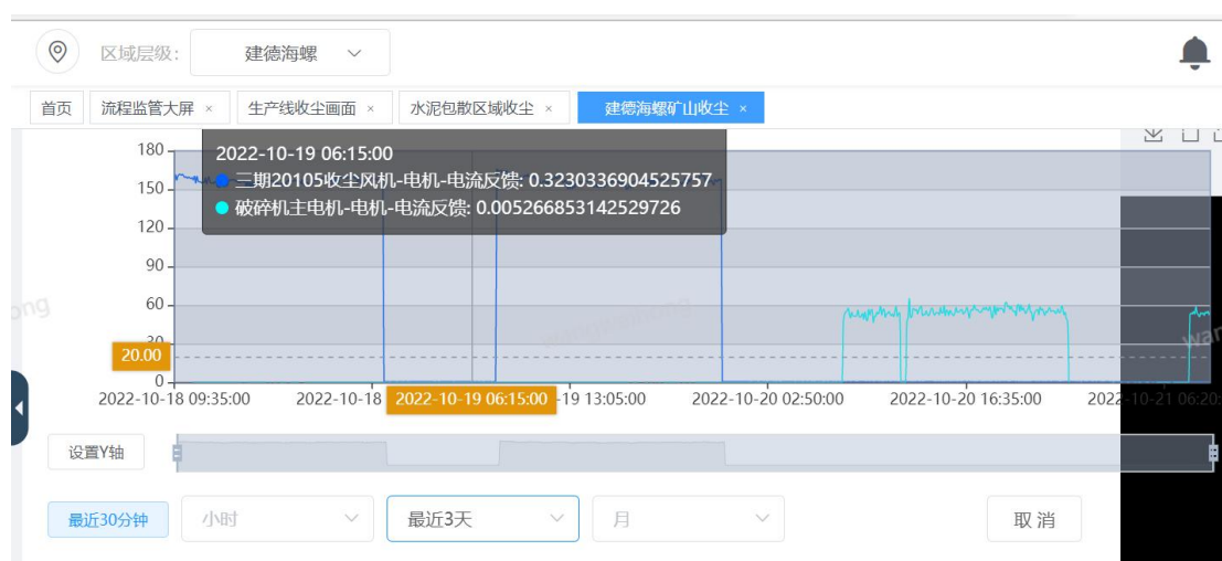
矿山#3 破碎机及除尘器同步运行曲线
