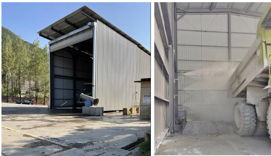
图 2.2-2 破碎下料点喷雾抑尘
