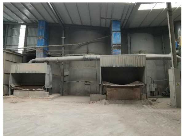
整体封闭平面库，下料口周边封闭，设收尘除尘
